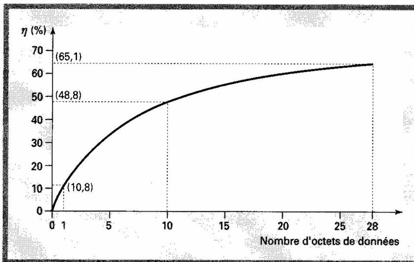
Dans le cas du protocole CAN, la taille de la trame dépend du nombre d'octet de données, mais également de la nature même du contenu de la trame, car le transcodage utilise la méthode du bit stuffing.
