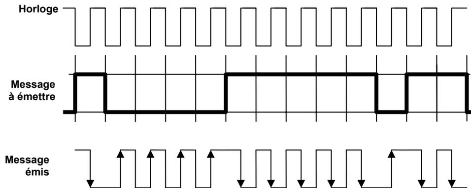
On substitue au niveau de tension (0/5Volts par ex.) représentatif de l'information (0/1) un changement d'état :
